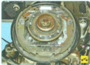
На рис. 9.4 показан тормозной механизм заднего колеса переднеприводного автомобиля. Тормозной механизм полноприводного автомобиля практически аналогичен по конструкции. Разница в расположении стяжных пружин и разжимного рычага привода стояночного тормоза.
