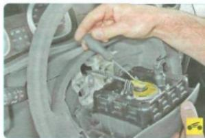
3. Снимите модуль подушки безопасности (см. «Снятие и установка подушки безопасности водителя», с. 304).
