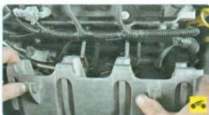
4. Сдвиньте со шпильки и снимите защитный кожух.
