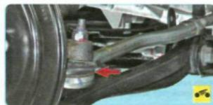
1. Проверьте состояние защитных чехлов наконечников рулевых тяг. Замените порванные, потрескавшиеся или потерявшие эластичность чехлы.
