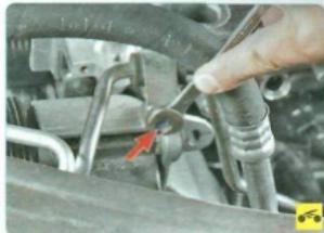
8. ...и болт верхнего крепления к кронштейну насоса гидроусилителя.
