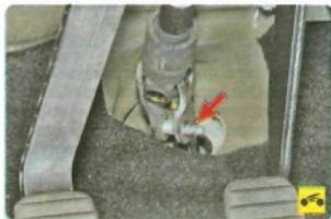
7. Под панелью приборов отверните гайку...
