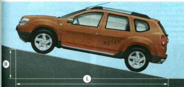
Рис. 9.5. Проверка стояночного тормоза
