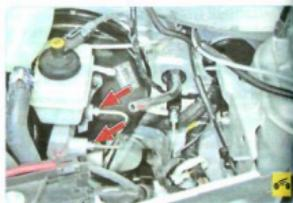
2. ... и соединения трубопроводов с главными тормозными цилиндрами.
