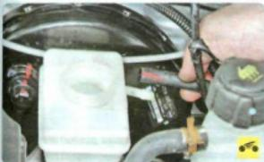
5. Снимите со штуцера бака шланг к главному цилиндру гидропривода выключения сцепления.
