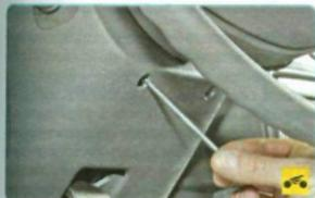
1. Выверните два винта крепления кожуха расположенные на нижней поверхности нижней части кожуха.
