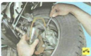
9. Таким же способом замените тормозную жидкость в рабочем цилиндре тормозного механизма левого переднего колеса.
