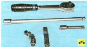
Для отворачивания труднодоступных гаек крепления вакуумного усилителя вам потребуется набор торцовых головок, удлинителей и воротков, подобных изображенному на фото.
