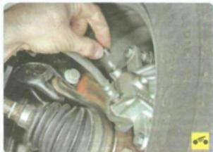
4. Очистите от грязи клапаны выпуска воздуха и снимите защитные колпачки клапанов рабочих цилиндров тормозных механизмов передних...
