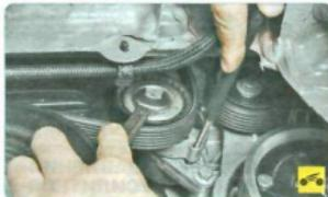
2. Снимите ремень привода вспомогательных агрегатов (см. «Замена ремня привода вспомогательных агрегатов», с. 69).
