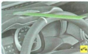
2. Установите линейку так, чтобы ее торец упирался в панель приборов, а плоскость линейки касалась наружной поверхности обода рулевого колеса. Не меняя положения линейки, поверните рулевое колесо вправо до момента начала поворота передних колес. В этом положении нанесите на обод рулевого колеса метку (закрепите проволоку).
