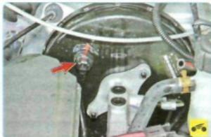
3. ...и плотность посадки штуцера обратного клапана в корпусе вакуумного усилителя.
