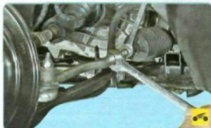
2. Ослабьте затяжку контргайки наконечника рулевой тяги.
