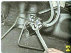
3. Проверьте, нет ли утечки жидкости из соединений тормозных трубок со шлангами.
