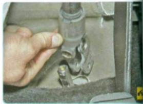
9. Сдвиньте вилку карданного шарнира с наконечника вала-шестерни.
