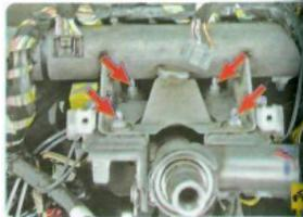
10. Выверните четыре болта крепления (расположение болтов для наглядности показано со стороны усилителя панели приборов)...
