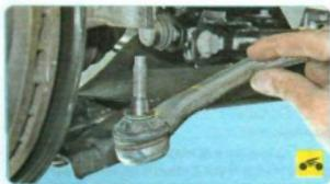
9. Выпрессуйте пальцы шаровых шарниров наконечников рулевых тяг из Бобышек поворотных рычагов (см. «Замена наружного наконечника рулевой тяги», с. 173).
