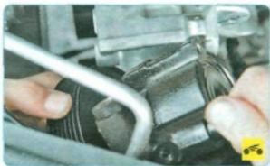
14. Выдвиньте насос из кронштейна. Сместите его назад и выньте из моторного отсека вверх.
