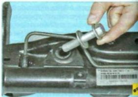
18. ...и выньте болты из отверстий кронштейнов 7 и 9 (см. рис. 8.1) крепления механизма.
