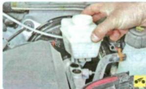
9. ...и снимите бачок, извлекая его патрубку из соединительных втулок.
