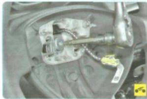
4. Выверните болт крепления рулевого колеса, удерживая колесо от проворачивания.
