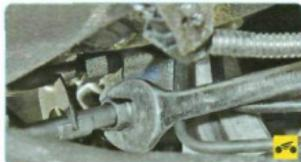
11. Отверните гайки крепления подводящего и возвратного трубопроводов к распределительному клапанному механизму 2 (см. рис. 8.1).
