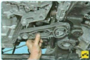
14. Выверните болты крепления кронштейна задней опоры подвески силового агрегата и снимите опору (см. «Замена задней опоры подвески силового агрегата», с. 71).
