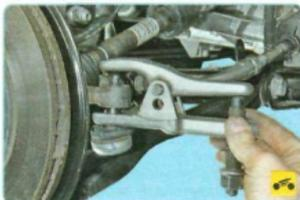
4. Установите съемник шаровых шарниров...
