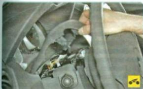
2. Потяните вверх и снимите верхнюю часть кожуха.
