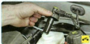
1. Отверните пробку бачка главного тормозного цилиндра.
