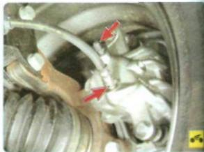
5. Осмотрите соединения шлангов с рабочими цилиндрами, клапаны для выпуска воздуха тормозных механизмов передних...
