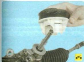
21. При необходимости отожмите отвёрткой фиксаторы и снимите держатель с уплотнителем в сборе.
