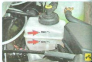
14. Долейте тормозную жидкость до уровня между метками «MAX» и «MIN» на стенке бачка и заверните пробку.
