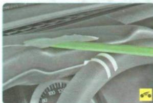
3. Не меняя положения линейки, поверните рулевое колесо влево до момента начала поворота передних колес. В этом положении нанесите на обод рулевого колеса вторую метку.
