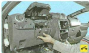
4. Снимите панель приборов (см. «Снятие и установка панели приборов», с. 274).
