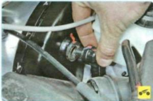
6. ...извлеките штуцер обратного клапана из корпуса вакуумного усилителя...
