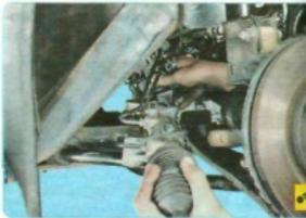
19. Немного приподнимите силовой агрегат и сдвиньте рулевой механизм вправо.
