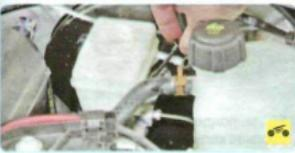
7. ...и извлеките его из отверстий бака и главного тормозного цилиндра.
