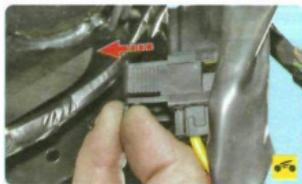
5. Сдвиньте в направлении стрелки на фото фиксатор колодки жгута проводов замка зажигания...
