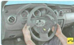
5. Резким ударом рук вдоль оси рулевого вала сбейте рулевое колесо с шлицевого наконечника вала.
