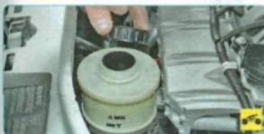
1. Снимите пробку и откачайте рабочую жидкость из бачка гидроусилителя рулевого управления.
