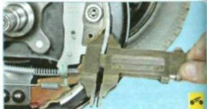
6. Измерьте толщину фрикционной накладки. Если толщина меньше допустимого
