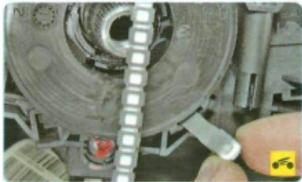
Для этого вставьте в специальный паз на внешней окружности кольца отрезок тонкой пластины. Очень хорошо подходит для этой цели отрезок от стяжного хомута чехла ШРУСа. Перед установкой рулевого колеса не забудьте вынуть фиксатор!
