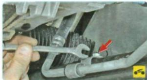
10. Отверните болт крепления подводящего трубопровода к подрамнику подвески.
