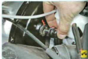
2. Отсоедините от вакуумного усилителя шланг к впускной трубе.
