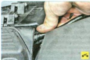
5. ...сожмите фиксатор и отсоедините вакуумный шланг от штуцера впускной трубы...
