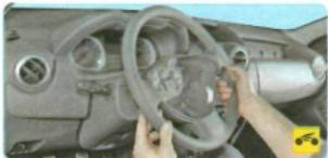
2. Снимите рулевое колесо (см. «Снятие и установка рулевого колеса», с. 171), предварительно установив его в положение, соответствующее прямолинейному движению.
