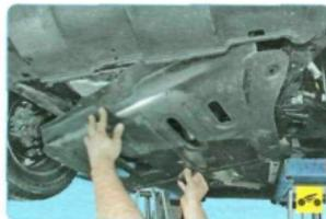
2. Снимите защиту картера двигателя (см. «Снятие и установка защиты картера и брызговики двигателя», с. 68).
