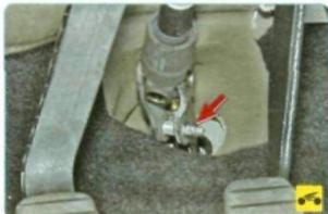
6. Под панелью приборов отверните гайку...
