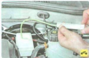
2. Откачайте (например, медицинским шприцем) старую тормозную жидкость из бачка...
