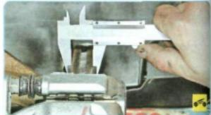
4. Измерьте толщину тормозного диска. Если его толщина меньше допустимого значения (см. табл. 9.1), замените тормозной диск (см. «Замена тормозного диска», с. 193).
