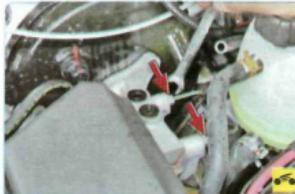
3. Отверните гайки крепления двух трубопроводов к главному тормозному цилиндру...
