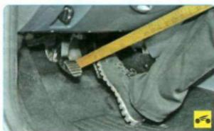
2. Отпустите педаль и повторно измерьте расстояние от накладки площадки педали до пола в свободном состоянии. Это расстояние должно быть 100–105 мм. Разность размеров при двух измерениях и является полным рабочим ходом педали, который должен быть 60–65 мм.
