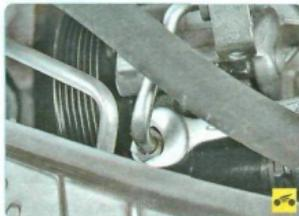
9. Отверните гайку крепления напорного трубопровода...
