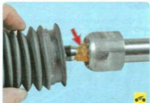
Перед установкой чехла нанесите силиконосодержащую смазку на зубья рулевой рейки и рабочую поверхность шарнира тяги.
