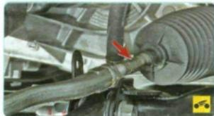
7. Сверните наконечник с рулевой тяги, подсчитывая количество оборотов. При необходимости удерживайте тягу от проворачивания ключом за лыски (показаны стрелкой).
