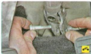
8. ...и извлеките из отверстия болт карданного вала промежуточного вала с валом-шестерней рулевого механизма.
