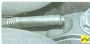
**Стояночный тормоз**, приводимый в действие механически, состоит из рычага, установленного на основании кузова между передними сиденьями, тяги с регу-
