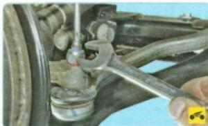
3. Отверните гайку крепления пальца шарнира к рычагу поворотного кулака, удерживая палец от проворачивания.
