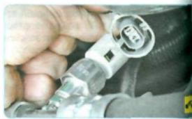
4. ...и отсоедините колодку жгута проводов от датчика.
