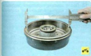
7. Измерьте диаметр рабочей поверхности тормозного барабана. Если он больше допустимого (см. табл. 9.1), замените барабан (см. «Снятие и установка тормозного барабана», с. 194).
