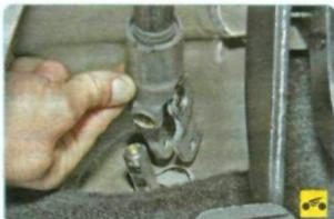
8. Сдвиньте вилку карданного шарнира с наконечника вала-шестерни рулевого механизма.
