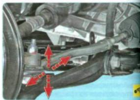
3. Качая рукой шарниры наконечников рулевых тяг в осевом и радиальном направлениях, проверьте наличие в них люфтов. Наконечники, шарниры которых имеют ощутимый люфт, замените. Проверьте также надежность затяжки гаек пальцев шаровых шарниров наконечников рулевых тяг.
