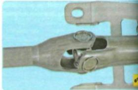
Крестовины вала рулевой колонки не подлежат ремонту, поэтому в случае их износа замените вал в сборе.
