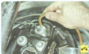
6. После этого наденьте резиновый шланг или прозрачную трубку на клапан выпуска воздуха рабочего цилиндра тормозного механизма правого заднего колеса и погрузите конец шланга в чистый прозрачный сосуд.
