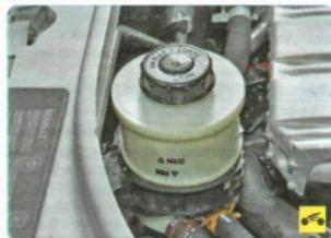
**Бачок** установлен на кронштейне в передней части моторного отсека на верхней поперечине рамки радиатора и соединен шлангами с насосом гидросилителя рулевого управления и с магистралью возврата рабочей жидкости. Для контроля уровня жидкости на полупрозрачной стенке бачка нанесены метки уровня.
