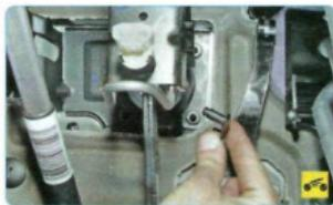
3. Если расстояние от накладки площадки педали до пола не соответствует указанному в п. 2 интервалом, отрегулируйте его, изменяя длину толкателя вакуумного усилителя тормозов. Отсоедините вилку
