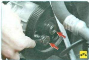
13. Проворачивая шкив, выверните по очереди два нижних болта переднего крепления.
