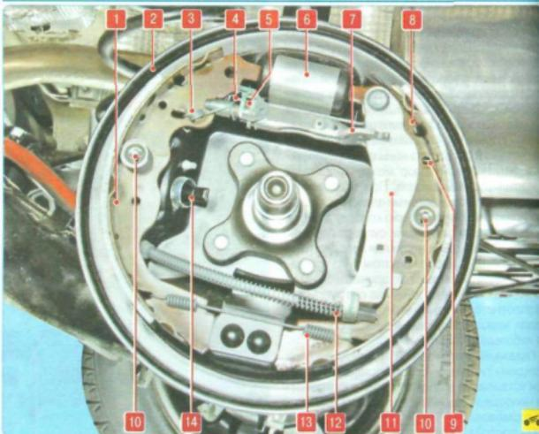
Рис. 9.4. Тормозной механизм заднего колеса: 1 – передняя тормозная колодка; 2 – щит тормозного механизма; 3 – серва механизма регулировки зазоров; 4 – верхняя стяжная пружина; 5 – регулятор зазоров; 6 – рабочий цилиндр; 7 – распорная планка; 8 – задняя тормозная колодка; 9 – оттяжная пружина распорной планки; 10 – опорная стойка; 11 – разжимной рычаг привода стояночного тормоза; 12 – трос привода стояночного тормоза; 13 – нижняя стяжная пружина; 14 – датчик частоты вращения колеса
