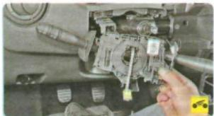
3. Снимите блок подрулевых переключателей в сборе (см. «Проверка и замена подрулевых переключателей», с. 228).
