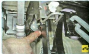
4. Отсоедините от педали тормоза толкатель вакуумного усилителя, для чего отстегните от педали пружинный фиксатор пальца...
