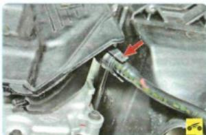
2. ...плотность посадки наконечника вакуумного шланга на штуцере впускной трубы...
