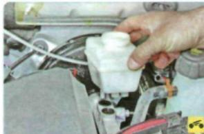
2. Для удобства работы снимите с главного тормозного цилиндра бачок (см. «Замена бака главного тормозного цилиндра», с. 186).
