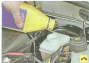
3. ...и залейте в бачок новую тормозную жидкость до нижней кромки наливной горловины.
