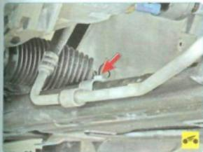
7. Проверьте состояние и надежность крепления трубопроводов линии высокого давления.
