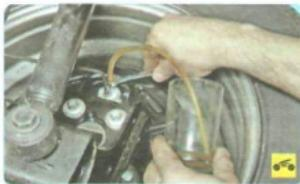
8. Отверните на 1/2–3/4 оборота клапан выпуска воздуха. Из шланга начнет вытекать старая (грязная) тормозная жидкость. Педаль тормоза в это время должна плавно дойти до упора. Как только жидкость перестанет вытекать, заверните клапан выпуска воздуха.
