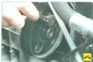
12. Выверните через отверстие в шкиве верхний болт переднего крепления насоса.
