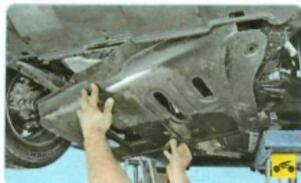
5. Снимите передние колеса и защиту картера двигателя (см. «Снятие и установка защиты картера и брызговики двигателя», с. 66).
