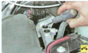
10. Если в процессе эксплуатации наблюдалась течь тормозной жидкости через соединительные втулки, извлеките втулки из отверстий корпуса цилиндра. Для этого, поддев отверткой край втулки, извлеките ее из отверстия главного тормозного цилиндра. Аналогично извлеките другую втулку.
