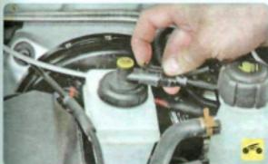
4. Установите пробку на место и отсоедините колодку жгута проводов от датчика уровня тормозной жидкости, отжав ее фиксатор. Снимите пробку.
