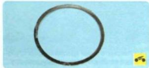
Уплотнительное кольцо главного тормозного цилиндра при каждой разборке соединения заменяйте новым.
