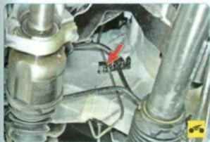
7. Проверьте крепление трубопроводов в держателях. Замените поврежденные держатели, так как их ослабление или поломка приводят к вибрации и, как следствие, к поломке трубопроводов.
