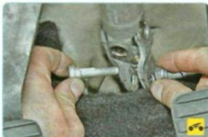
7. ...и извлеките болт клеммового соединения рулевого вала с валом рулевого механизма.
