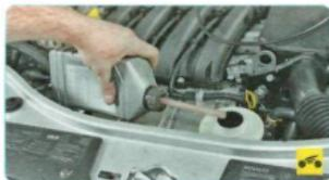
9. Залейте рабочую жидкость и удалите воздух из системы гидроусилителя (см. «Прокачка системы гидроусилителя рулевого управления», с. 174).
